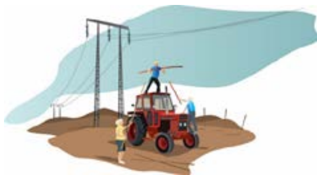
Bild 31 - Parkera inte fordon inom ledningens försiktighetszon.
